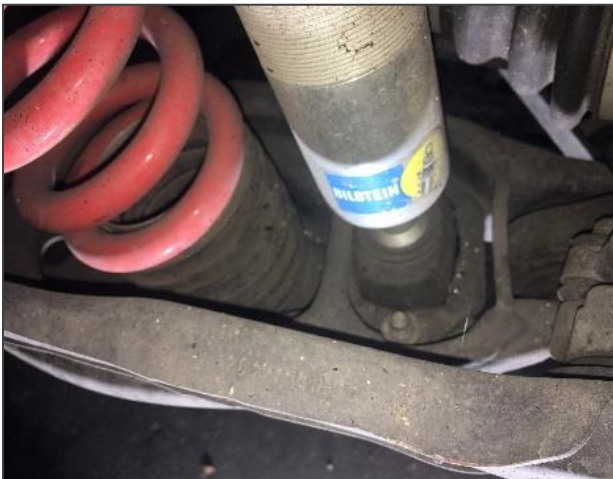
Abb. 4: Richtige Befestigung Figure 4: Correct mounting
