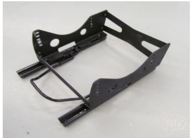
Bild 3.3.5: Sitzschiene und Konsole (2015)
