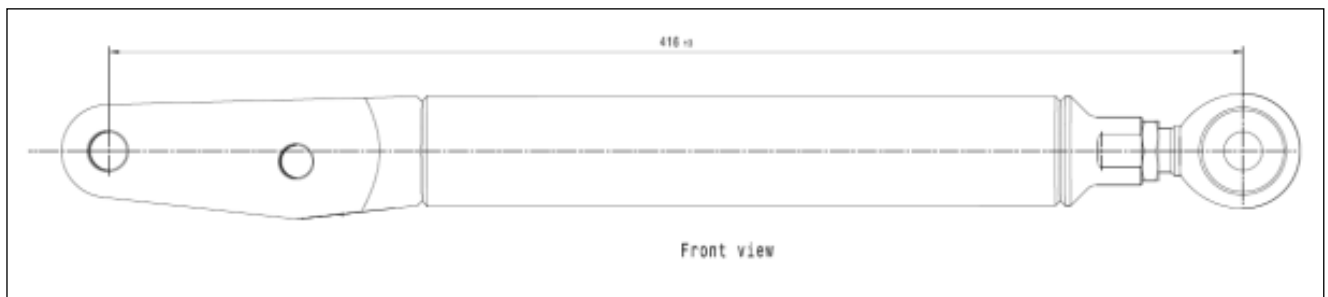
Abb. 2.6.1: 8 417 254 Sturzlenker Hinterachse 416 mm (+/-2 mm)
