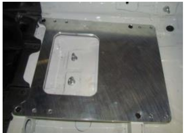
Bild 3.3.2: Grundplatte Sitzbefestigung montiert auf Traverse Sitzbefestigung
