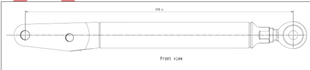
Abb. 2.6.1: 8 417 254 Sturzlenker Hinterachse 416 mm (+/-2 mm)
