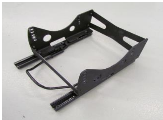
Bild 3.3.5: Sitzschiene und Konsole (2015)
