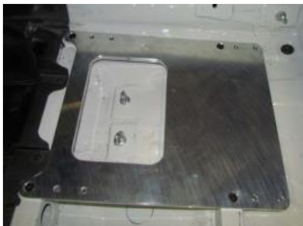
Bild 3.3.2: Grundplatte Sitzbefestigung montiert auf Traverse Sitzbefestigung
