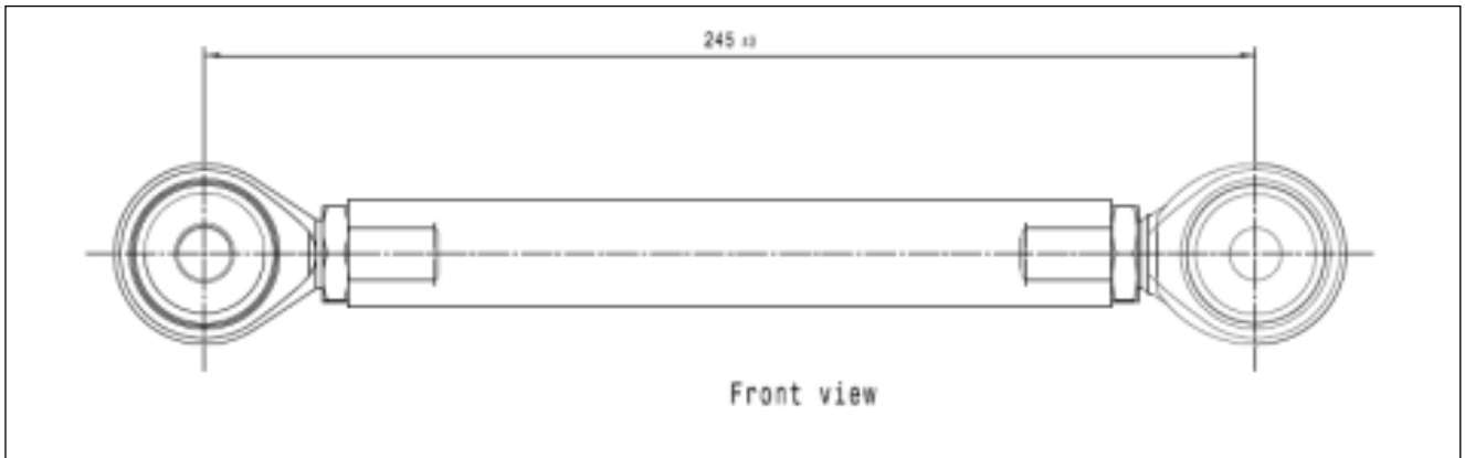
Abb. 2.6.2: 8 417 242 Führungslenker Hinterachse 245 mm (+/-2 mm)
