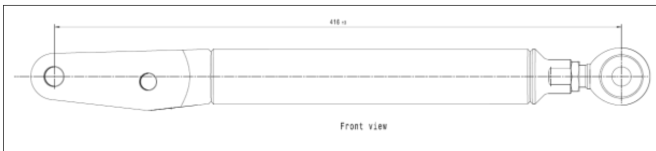
Abb. 2.6.1: 8 417 254 Sturzlenker Hinterachse 416 mm (+/-2 mm)
