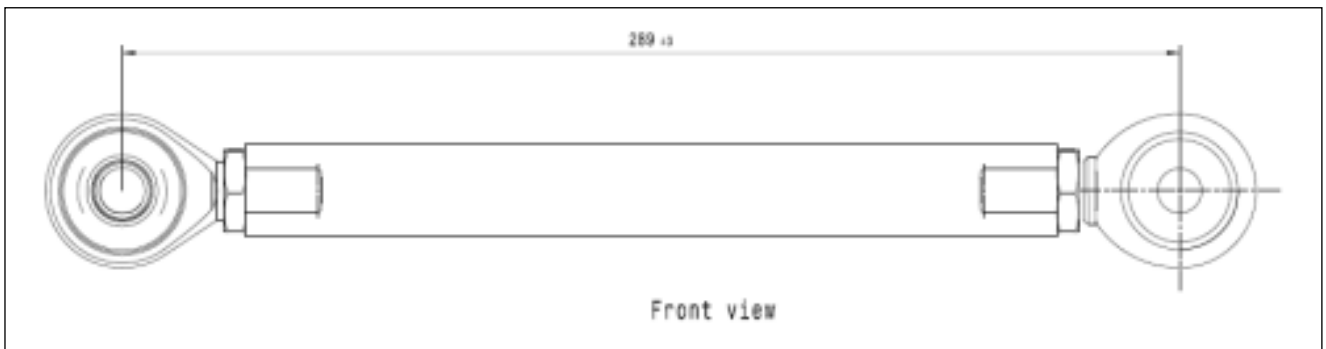
Abb. 2.6.3: 8 417 247 Querlenker Hinterachse 289 mm (+/-2 mm)
